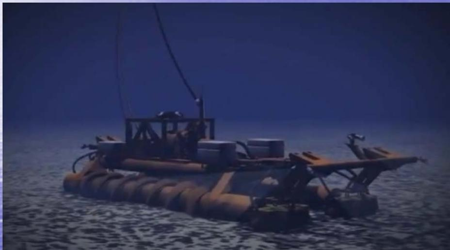
Донный добычный модуль с шнековым двигателем
