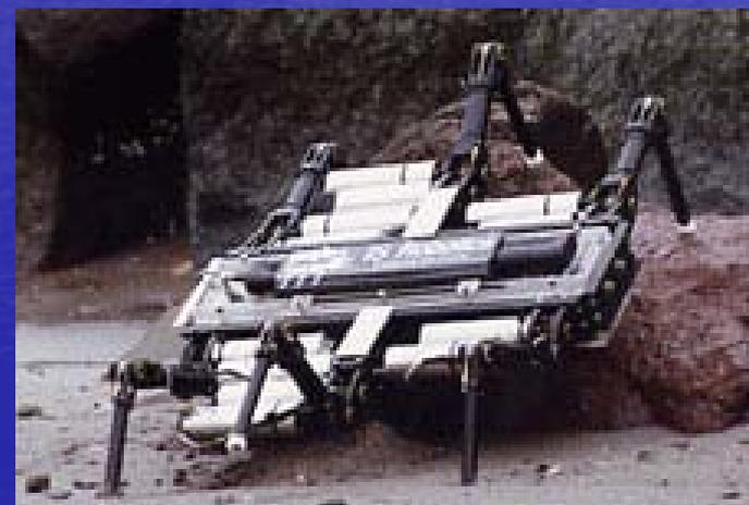
Подводный шагающий робот Arie1-II (США) для сбора противодесантных мин в зоне приобья
